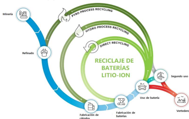
Figura 3. Esquema con las diferentes rutas de reciclado de baterías de litio (Fuente: Argonne National Laboratory)
