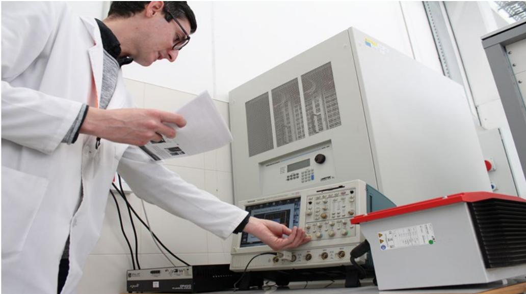
**Ilustración 4: Montaje de un ensayo de integración de electrónica de potencia con el equipo HiL y el Gemelo Digital eléctrico**
